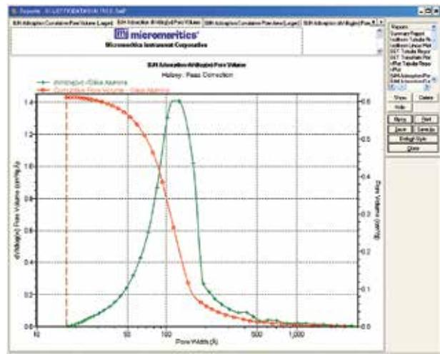
*Gemini VII 2390*包括一个专用的传感器用于连续监测低温浴的饱和压力。这允许*Gemini VII 2390*快速测量吸附等温线并确定介孔材料的孔隙体积、面积和大小分布。
