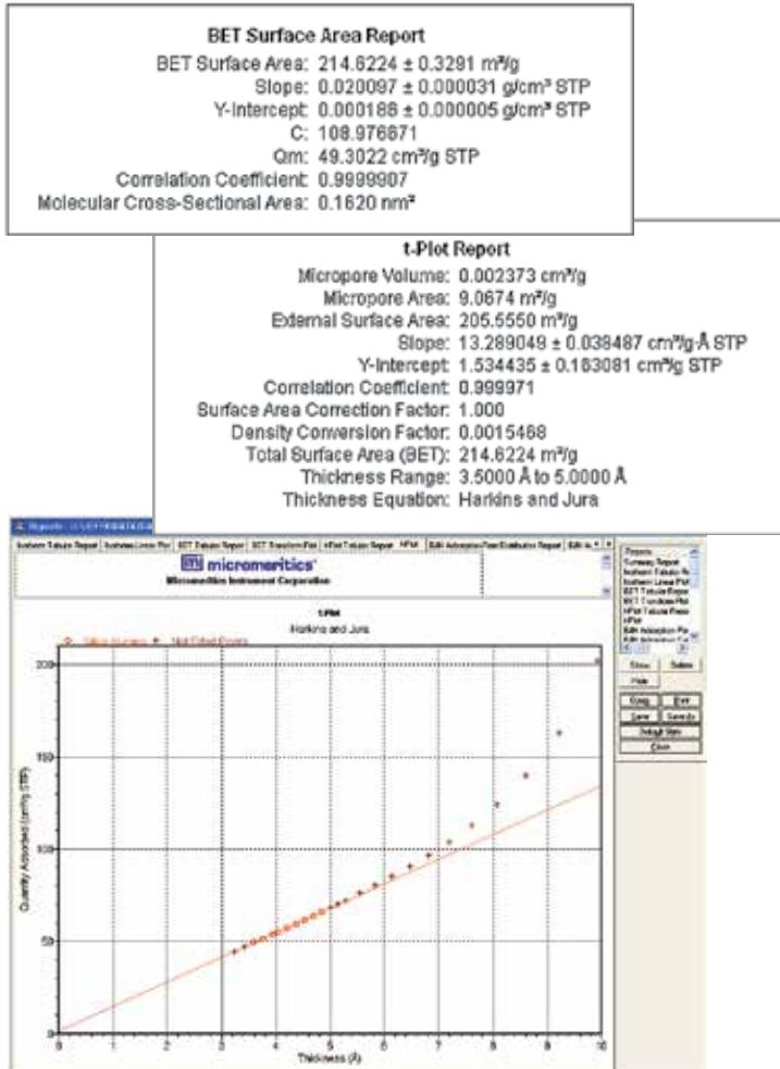
*Gemini VII* 2390系列分析仪提供快速表面积分析。独特的平衡管设计允许使用氮气来精确地测量众多材料的BET比表面积，包括许多低比表面积。所有的*Gemini*型号都使用标准的*t*-plot计算模型来测定微孔体积、微孔表面积和外表面积。
