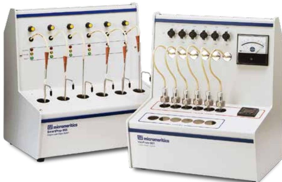
VacPrep™ 061提供两种方式除污染物。除了流动气体法外，它提供通过加热和抽真空法制备样品。这种设计可使用户根据自己的样品材料或者应用选择合适的制备方法。VacPrep有六个脱气站，每个站都可选真空制备或流动气体制备。针阀设计使气体流动缓慢，防置样品被吹走。
